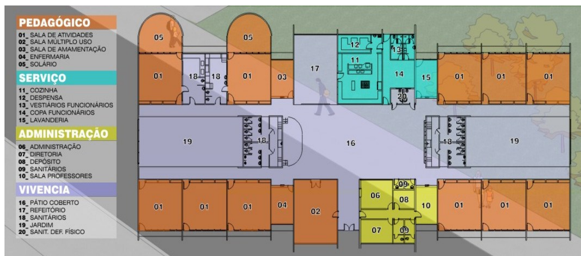
Figura 4. Planta baixa da área interna dos CEIs “Naves Mãe” – divisão de setores.
