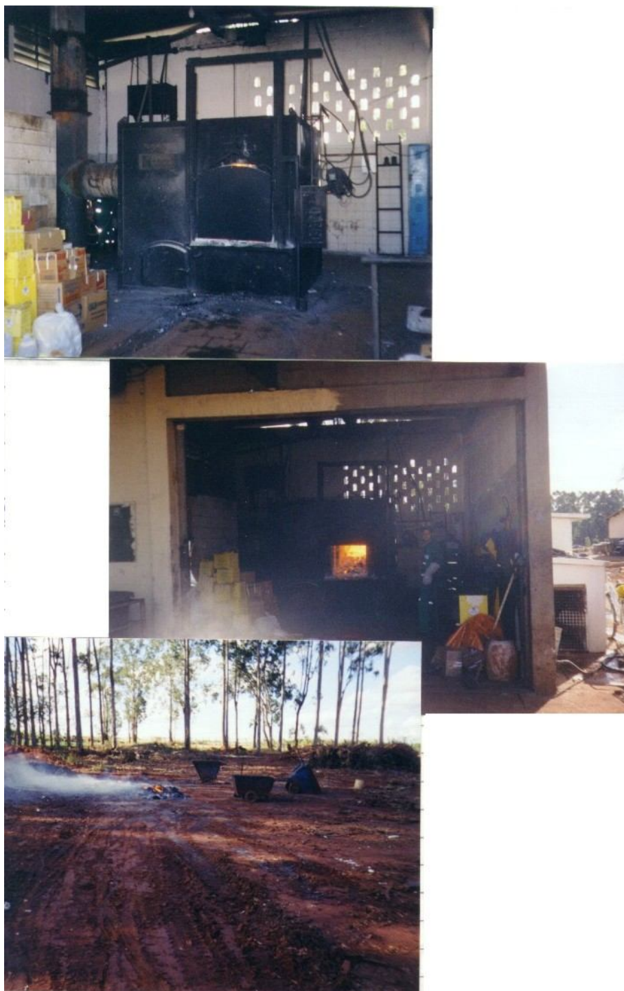
FIGURA 29 C - Lixo Hospitalar que tem a coleta, incineração e disposição feitas separadamente – Araraquara/S.P.
