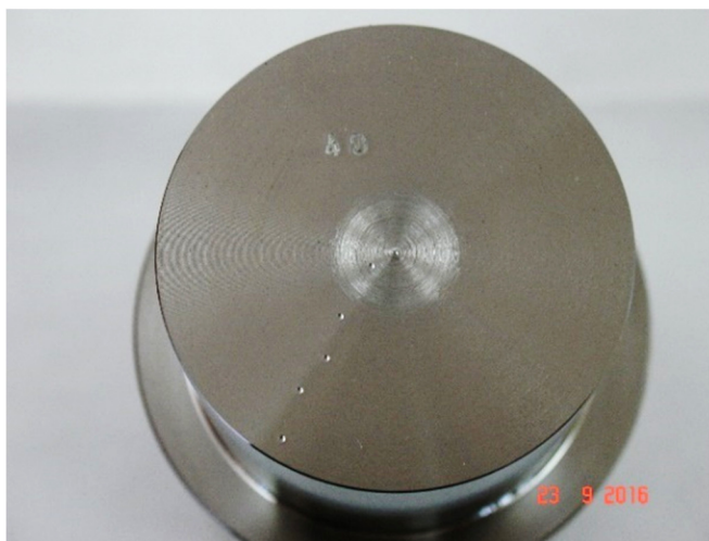
Figura 3-8 - Medidas de dureza na seção transversal do material
