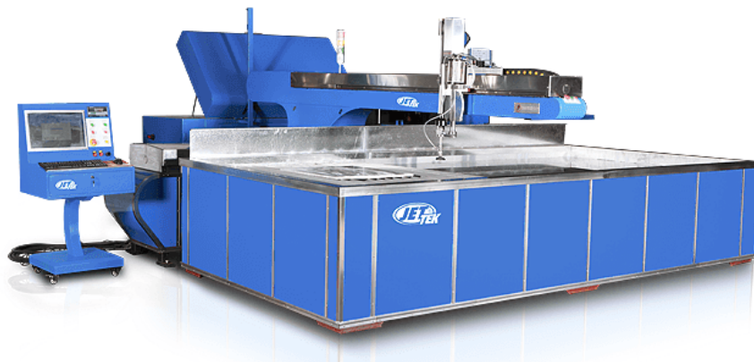
Figura 2-6 - Máquina de corte por jato de água (Adaptado de Silveira [27])
