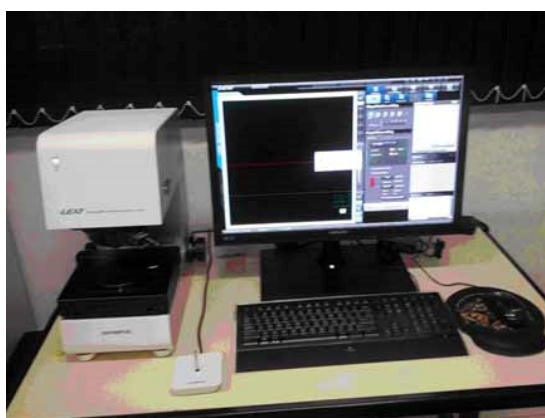
Figura 3-3 - Conjunto microscópio-computador utilizado para fazer as medições dos raios das arestas de corte
