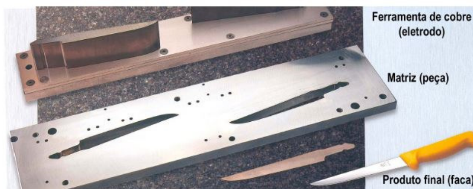
Figura 2-12 - Eletrodo de cobre, matriz e faca de cozinha [46]
