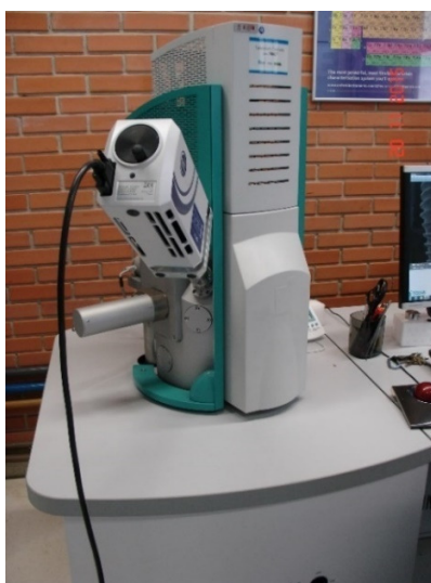
Figura 3-2 - Microscópio eletrônico de varredura da empresa Tescan
