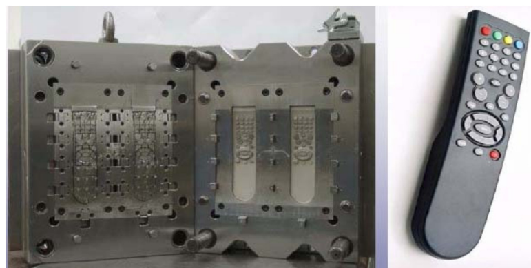
Figura 2-11 - Molde de injeção de plástico, em aço de elevada dureza, confeccionado por eletroerosão [46]
